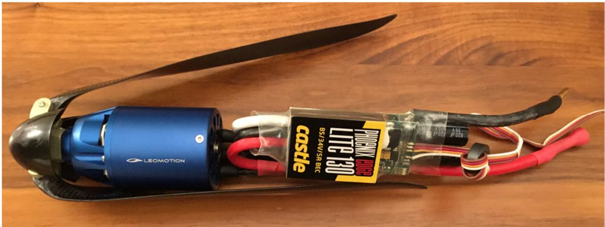
*Saldare il regolatore al motore per risparmiare spazio – Azionamento da 100A con regolatore da 130A*
